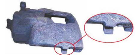
Befestigung gebrochen / mounting broken bracket
