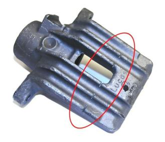
Starke Beschädigung / unautorisierte Reparatur / Konstruktive Veränderung
