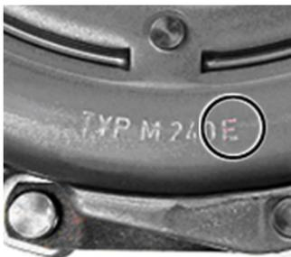
Abb. 2: Xtend Kupplungen tragen den Zusatzkennbuchstaben **E**. Beispiel: M 240 E
