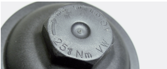
Εικόνα 2: Στοιχεία ροπής στρέψης στο κάλυμμα του περιβλήματος
