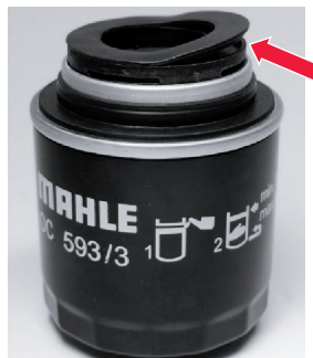
Abbildung 2: Die obere Dichtung (zur Verdeutlichung angehoben) übernimmt das Verschließen der Leerlaufmechanik im Flansch.
