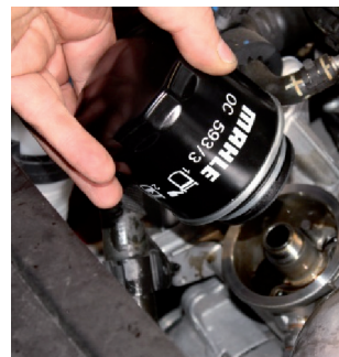
Abbildung 3: Beim Lösen des alten Filters muss darauf geachtet werden, dass kein Motoröl auf den Riementrieb oder in den Generator gelangt.
