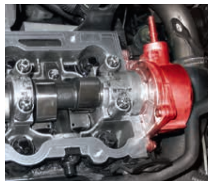
Vakuumpumpe und Nockenwelle im Opel Vectra B (hervorgehoben)
