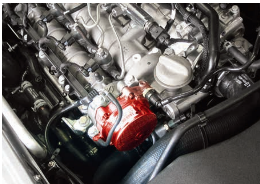
Vakuumpumpe im Opel Vectra B (hervorgehoben)
