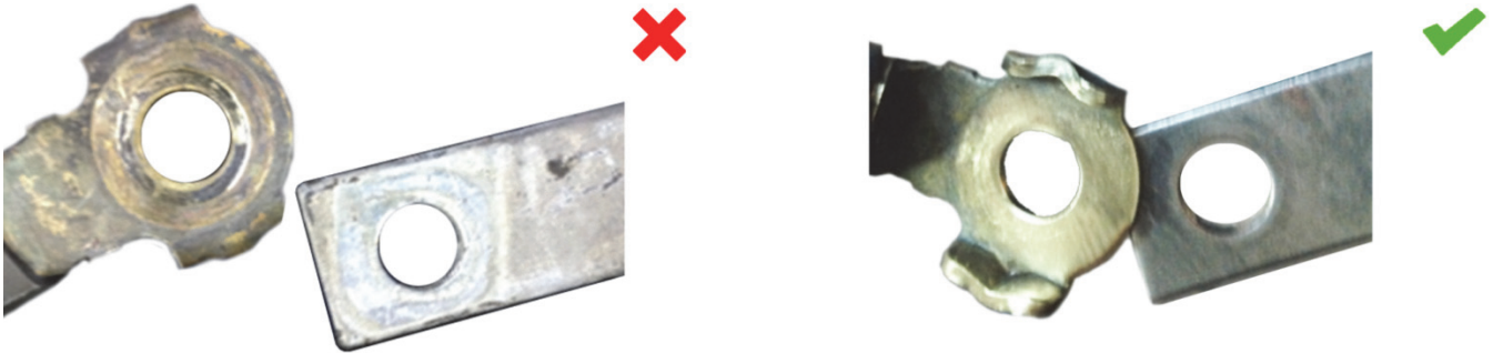
Abb. 1: Masseverbindung vor der Reinigung: Kontakt schlecht
