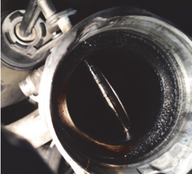
Abb. 4: Klappe des Abgasrückführungsventils (AGR-Ventil) verkocht
