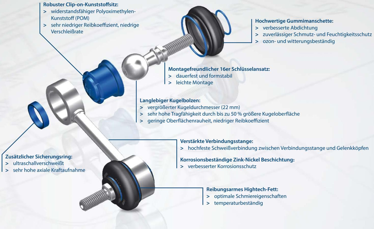
Unsere Ingenieure entwickeln mit Leidenschaft permanent alle Komponenten unserer MEYLE-HD Koppelstangen weiter. Um den Ein- und Ausbau für unsere Kunden zu erleichtern, verfügen immer mehr MEYLE-HD Koppelstangen nun über einen Schlüsselansatz am Kugelbolzen. Ein besonderer Vorteil, vor allem wenn die Originalversion diesen Mehrwert nicht bietet.
