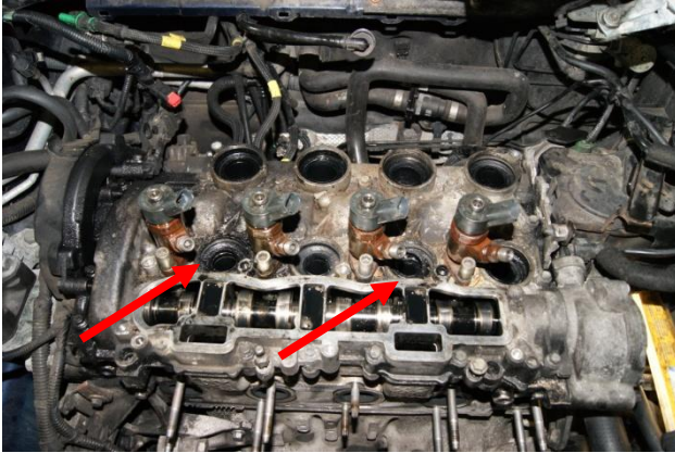
Bild 1: Gasübertritte am Ansaugkrümmer- neu abdichten
