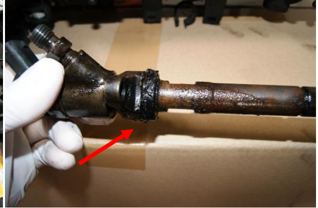
Bild 2: Halterung am Düsenstock undicht- neu abdichten
