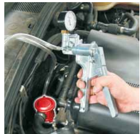
Prüfen eines Sekundärluftventils mit einer Unterdruckhandpumpe
