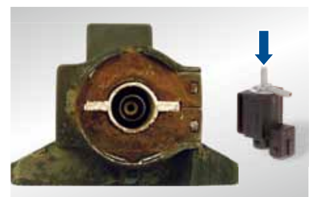
Korrodiertes Elektromagnetventil (geöffnet)
