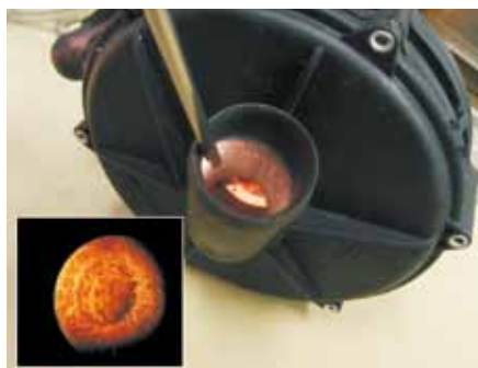
Blick in den korrodierten Einlauf einer Sekundär-luftpumpe
