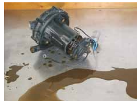
Flüssiges Abgaskondensat aus einer Sekundär-luftpumpe
