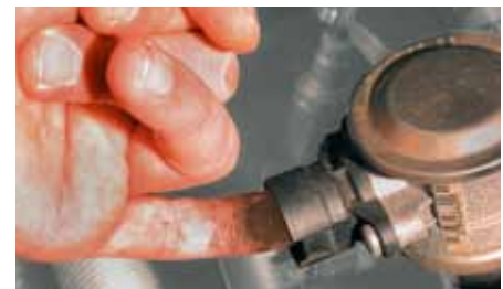
„Fingerprobe“ am Sekundärluftventil im BMW 520i (hervorgehoben) Sind auf dieser Seite Ablagerungen vorhanden, ist das Rückschlagventil undicht und muss erneuert werden.
