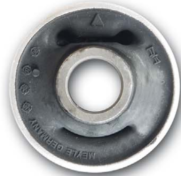
Lagerbuchse mit optimierter Gummiauffüllung
