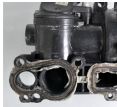
Abb. 5: Undichtigkeiten durch zusätzliche Dichtmittel (Schadensbild)
