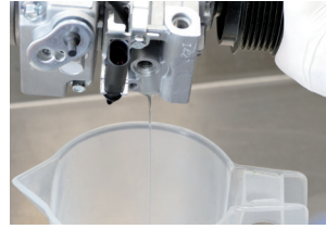
Resim 1: Yeni kompresörden yağı boşaltın ve yağ miktarını tespit edin
