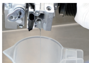
Zdjęcie 1: Spuścić olej z nowego kompresora i określić ilość oleju
