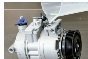
Εικόνα 2: Πλήρωση συμπιεστή με την προβλεπόμενη ποσότητα λαδιού στο σύστημα και εκ νέου σφράγιση
