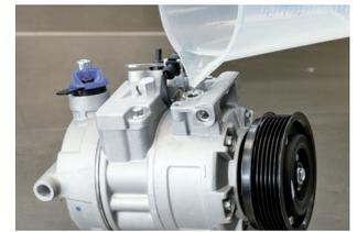
Figura 2: Llenar el compresor con la cantidad de aceite de sistema prevista y volver a cerrarlo
