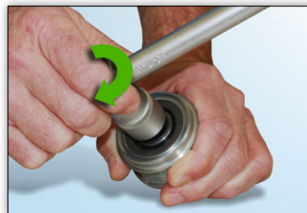
Bild 5: Im Uhrzeigersinn lässt sich das Werkzeug mit leichtem Widerstand uneingeschränkt verdrehen.
