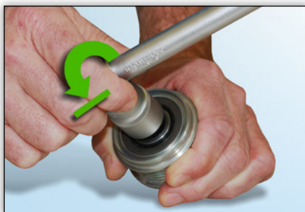
Bild 4: Gegen den Uhrzeigersinn blockiert das Werkzeug direkt und lässt sich nicht verdrehen.
