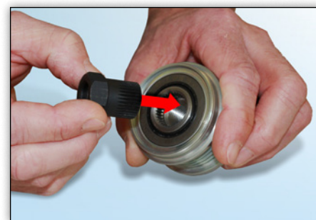
Bild 3: Den entsprechenden Adapter in die Freilaufriemenscheibe einsetzen.
