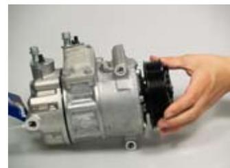
Antriebswelle des Kompressors zwecks Verteilung des Öls 8–10x drehen.
