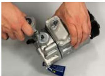
Ist keine Ablassschraube vorhanden, dann die Entleerung über die Hoch-/Niederdruckanschlüsse vornehmen.
