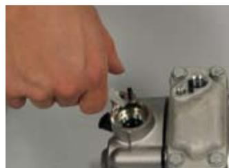
Über den Hochdruckanschluss nach Herstellerangaben mit PAG Öl befüllen.
