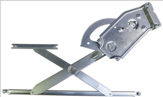
POWER WINDOW LEFT ALZACRISTALLI ELETTRICO SX
