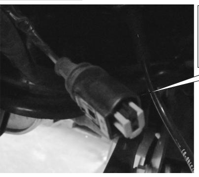
Original Leitung in die mitgelieferte Buchse mit Abdichtungen ganz einschieben und einrasten. Pinposition / Kabelfarbe ist nicht relevant. Anschließend Steckergehäuse verriegeln.
