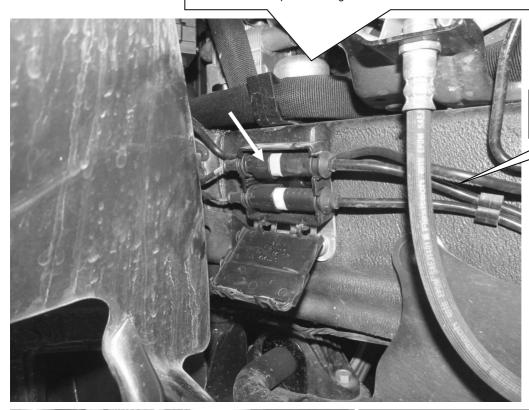
Zuleitung zum Dämpfer Line to the damper
