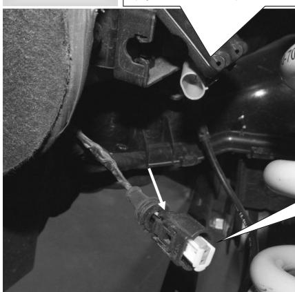
Anschließend das Gehäuse am Kabelbaum des Fahrzeugs mit einem geeignetem Werkzeug auspinnen.
