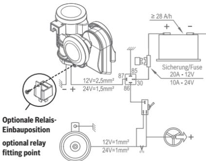
Anschlussdiagramm mit an der Fahrzeugkarosserie geerdetem Pol am Schalter Hupe – Wiring diagram with ground lead to horn button
