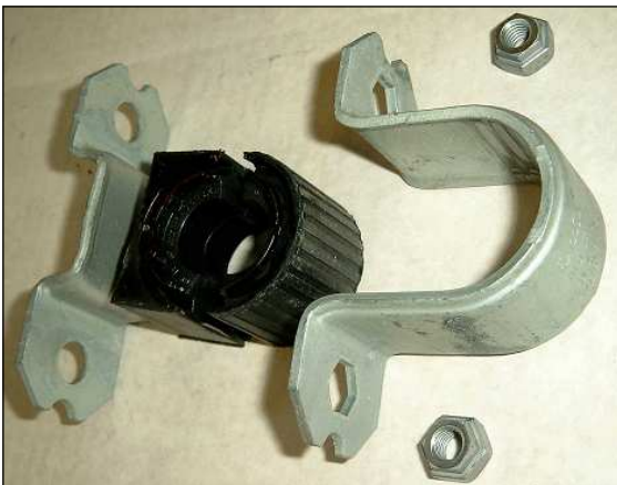
Abb. 3: Demontierte OE Lagerschellen & -gummis Fig. 3: Dismantled OE stabilizer clamps and rubbers
